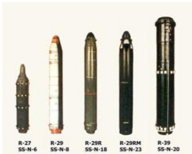
Figure 9 : Les systèmes soviétiques lancés de sous-marins. Le SS-N-20 premier engin intercontinental à propulsion solide n'est déployé qu'en 1984. (source FAS)
